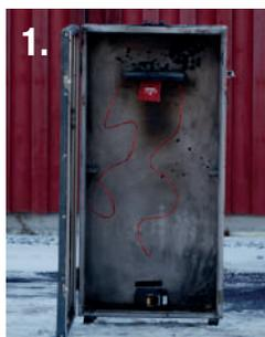
1. Se colocó una batería de litio en la parte inferior del gabinete y la(s) unidad(es) MAUS se colocaron en la parte superior.
